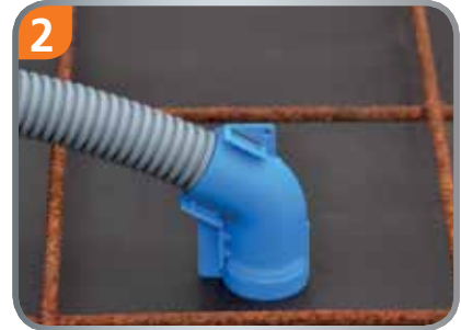
Auf das Unterteil stecken. Absolut sichere Zugentlastung!
