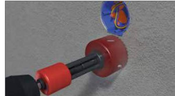
...oder mit einer Bohrkrona aufgebohrt werden.
