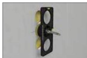
Schnellspannhebel öffnen und ins vorhandene Loch einsetzen.
