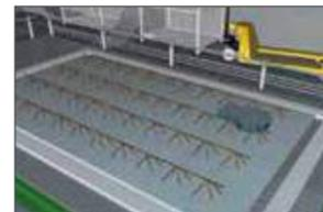
Betonfertigteile werden gegossen.
