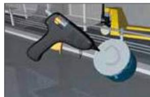
XL 170 Einbaugehäuse mit Heißkleber auf den Schaltisch kleben.
