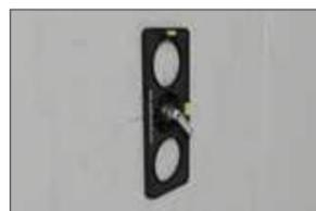
Durch das Schließen des Hebels wird die Bohrschablone fixiert.
