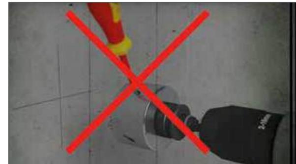
Herkömmliches und Zeitaufwändiges entfernen des Bohrkerns.
