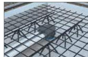
Rohre anschließen, obere Bewehrung einbringen und betonieren.
